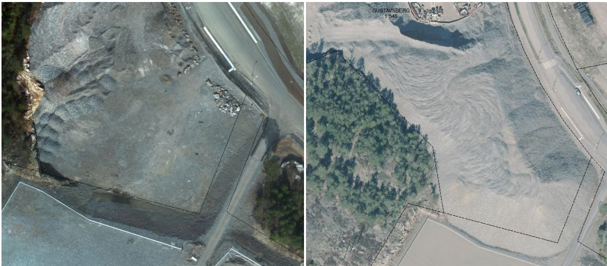
Figur 3. Gustavsberg 1:545. Vänster bild: 2011, innan krossmaterial fyllde upp sänkan i den södra delen av fastigheten. Höger bild: 2018, krossupplagets nuvarande utbredning. ( Källa: Geosecma webbkarta, Värmdö kommun).
